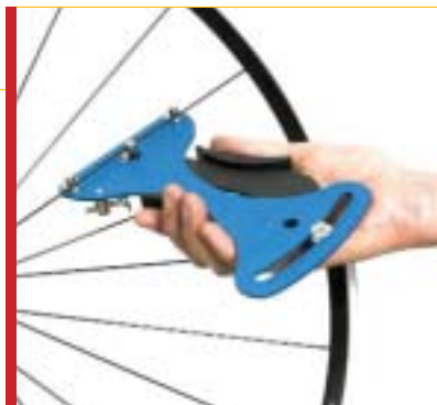
W ocenie naprężenia szprych pomaga odpowiedni przyrząd pomiarowy.
